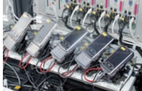
Ruf doch mal an: Vier plus ein Reserve-Handy dienen als computergesteuerte Dauertelefonierer.
